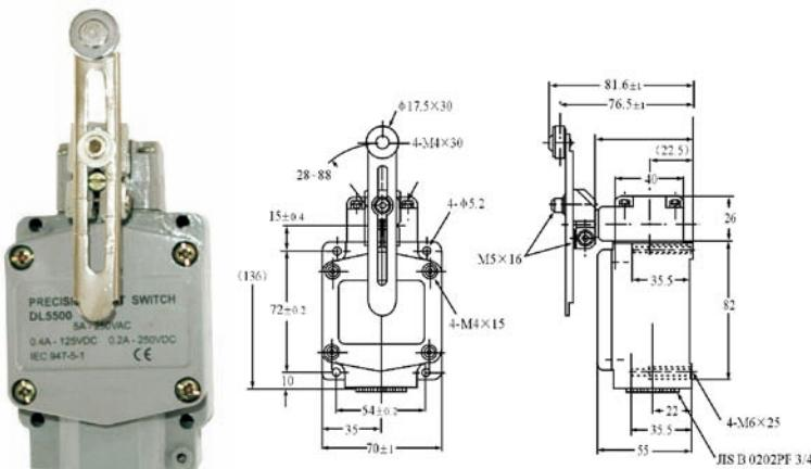
根据转轴的位置和数量,可调整不同的触点接触情况
