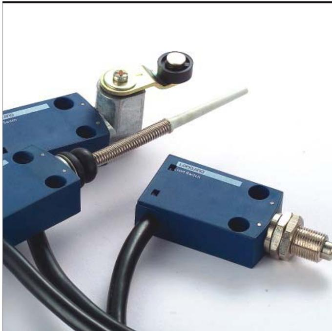
该系列小型限位开关，外壳由特殊强化的塑料组成，开关具有体积小、外形美观，选用塑料材质为开关本体，具有双重绝缘功能，头部、本体和连接部件模块化，可互换，任意角度可调，带线缆密封管进线及快速连接器，触点模式有：NC+NO; NC+NC。
